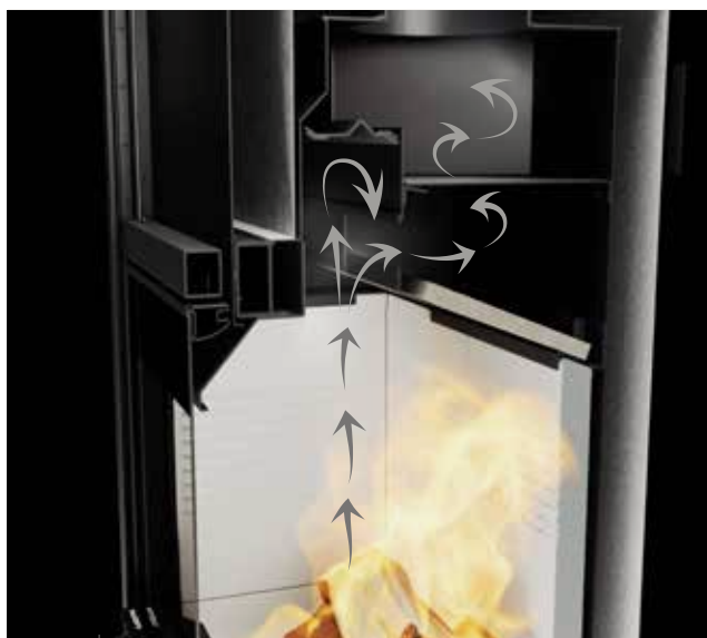
1- A PORTA CHIUSA. La valvola By-pass è chiusa e i fumi vengono convogliati nello scambiatore di calore.
